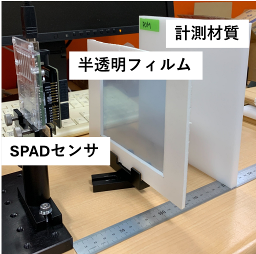
図 6: 二層構造物体の計測環境
