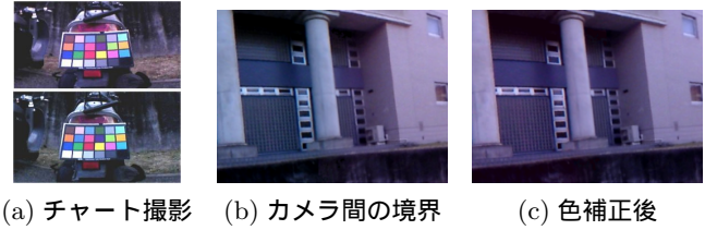
図 8 カメラ間の色補正. 異なるカメラで撮影されたカラーチャート (a) を元に，それらのカメラの映像境界部分 (b) で色補正を行った結果 (c).
