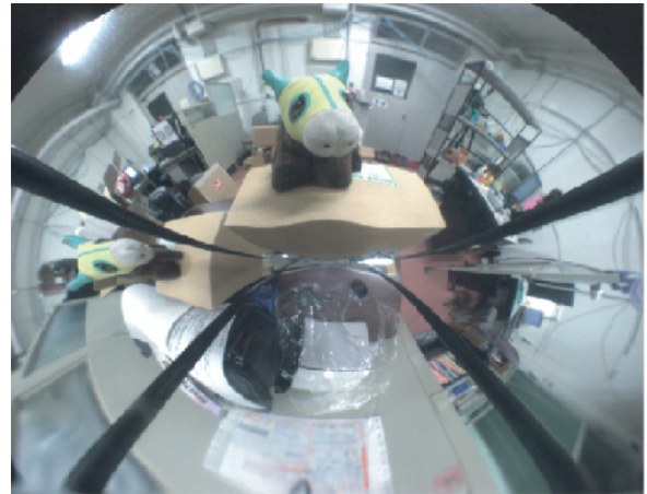
図 2 図 1 の視覚系で撮像した入力画像例。2 つの同じ大きさの馬のぬいぐるみを同じ奥行き (200mm) に配置しているにもかかわらず、方位により違った大きさに射影される。
