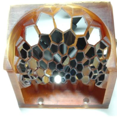
図 10: 制作した亀甲多面鏡
