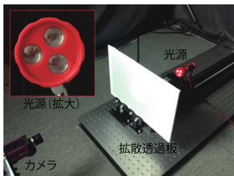
図 2 実験環境外観図. 光源はリフレクターとレンズを持つ.
