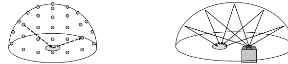
(c) 光源とセンサを半球状に配置 (d) 反射屈折光学系を工夫
