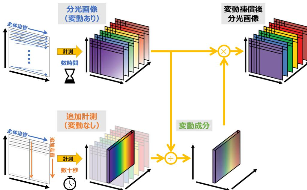
図 3：自然光の変動を補償した分光画像の取得
