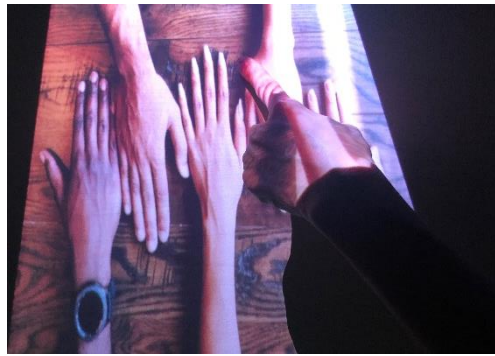
図1 映像が手にも投影されることにより、コンピュータが指を検出するときに手がかりとしている指の色や形を見出すのが難しくなる。また、本物の手と映像上の偽物の手を区別するのは、人間の目では可能であっても、コンピュータではまだ困難である。
