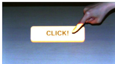
図5 従来1台のカメラでは難しかったタッチの有無を判定できる。
